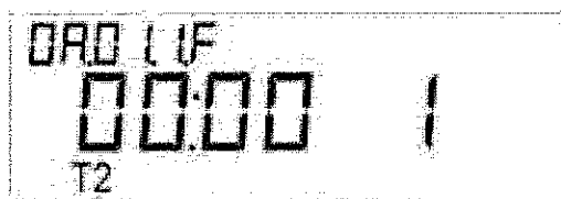
Рисунок 2.14 – Меню 7 кадр 10. Начальный кадр подгруппы. Время начала тарифной зоны 1 с указанием номера тарифа
